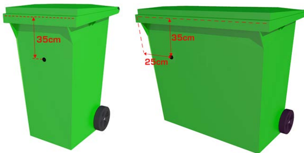
Figur 5. Centrerad montering av ID-tag (transponder) på 90-370 liters kärl (vänster bild) och förskjutet montering på 660-liters kärl (höger bild).
