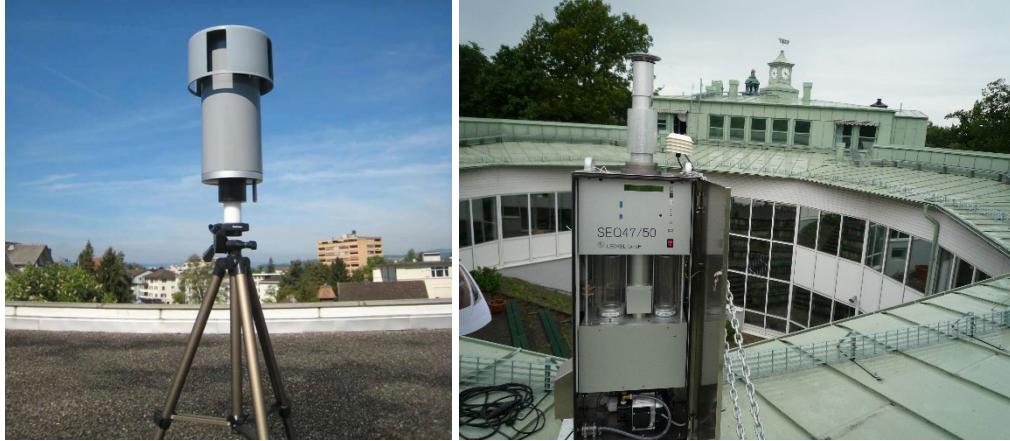
Figur 2. Bilder på passiv Sigma-2 provtagare för depositions-mätningar (vänster) och aktivt pumpat Leckel-instrument (höger) för partikelmätningar, varav den senare används inom Delprogrammet: Partiklar i luft (Källa: Particle Vision (v) resp. IVL Svenska Miljöinstitutet (h) ).
