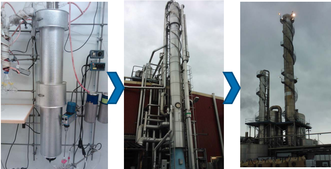
Figur 1 Exempel av ett processutvecklingsarbete: En destillationsprocess som först testats i labbskala, sedan i en pilotanläggning för att till slut bli en färdig fullskalig anläggning.
