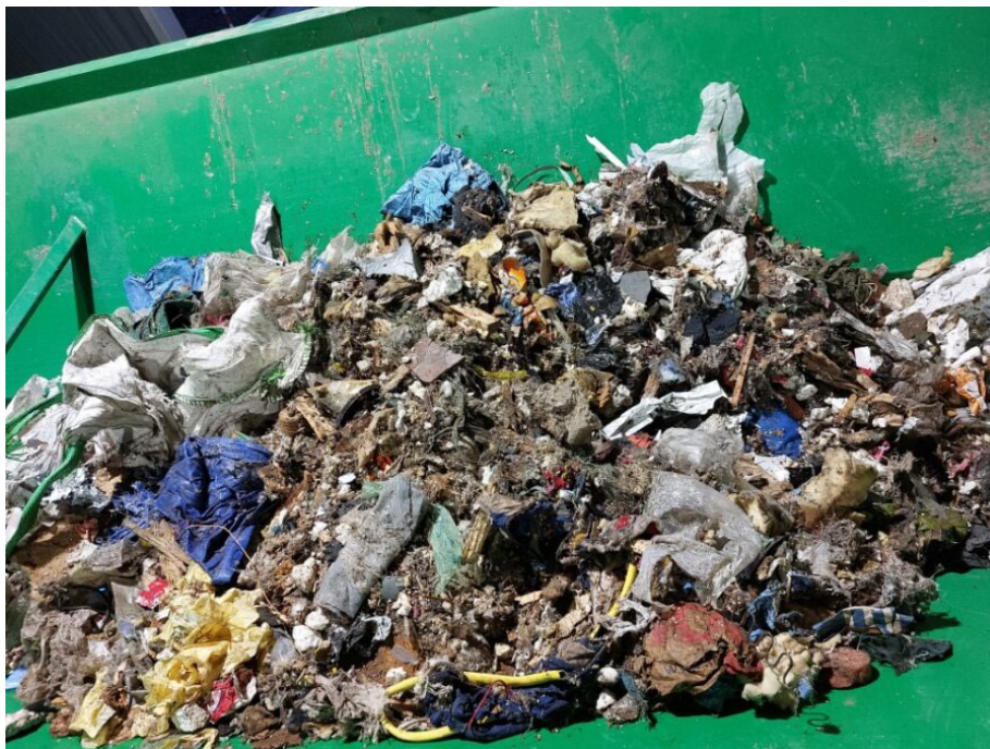
Figur 36: Bild på prov 6 (ÅVC och industri) som senare skickats till en extern aktör för plockanalys från Vattenfall Värme i Uppsala.
