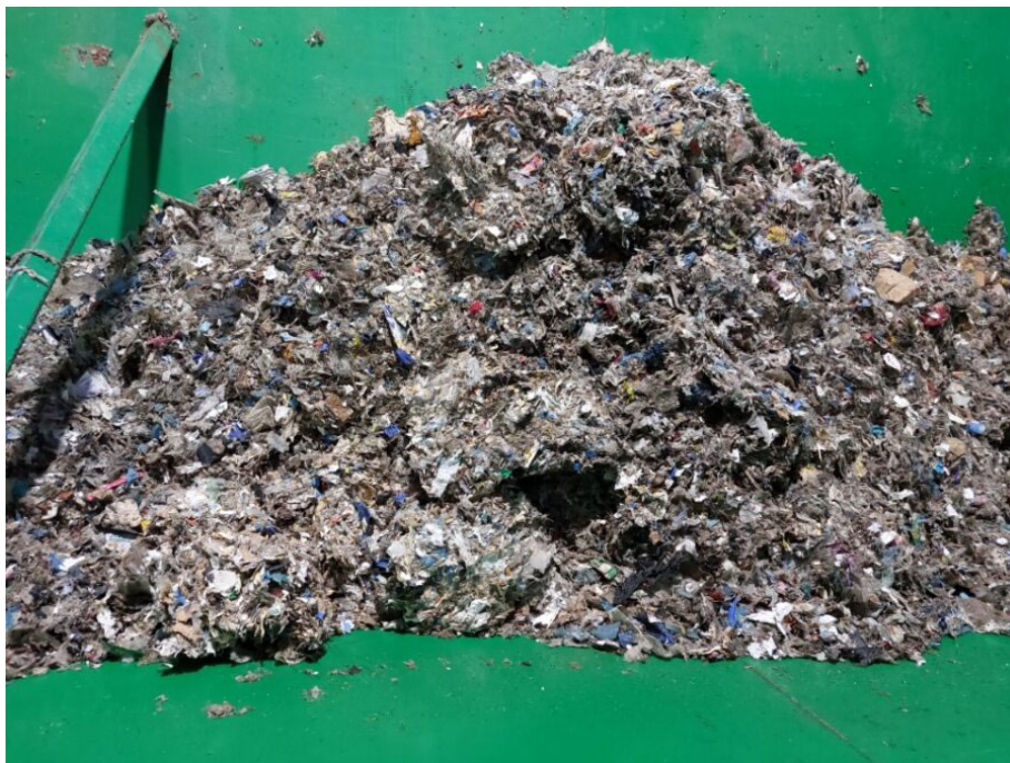
Figur 34: Bild på prov 4 (shredded fraction) som senare skickats till en extern aktör för plockanalys från Vattenfall Värme i Uppsala.
