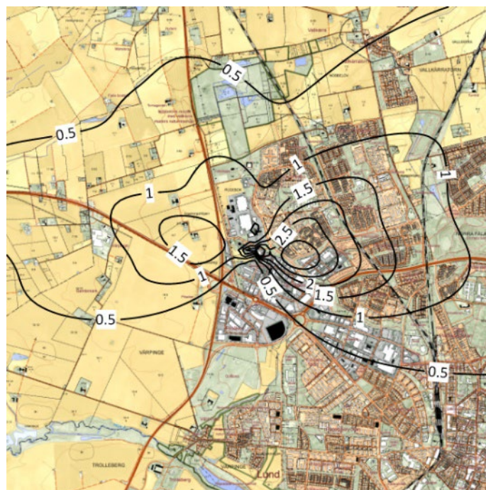
Figur 9. Spridningskartor som visar beräknat haltbidrag utan topografi (övre bilden) och med topografi (nedre bilden). Beräkningarna är gjorda med ADMS.
