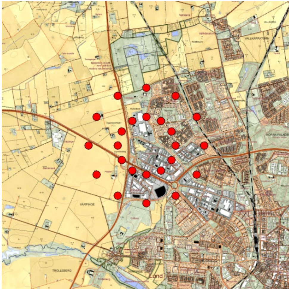
Figur 4. Karta som visar mer detaljerad placering av de närmsta punkterna kring källan, för vilka haltbidraget har analyserats. Den inre ringen är 500 m från källan och den yttre är 1000 m från källan.
